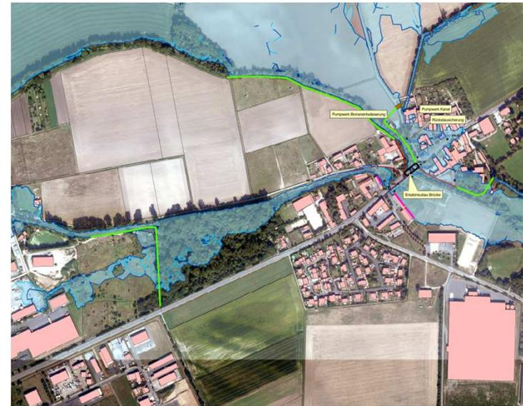
→ Da bei Drosselung des Abflusses im Silberbach der erhöhte Abfluss im Castellbach ohne einen kompletten Ersatzneubau der östlichen Brücke und einer massiven Gewässeraufweitung lediglich mit rund 0,5 m Aufstau abgeführt werden kann, lässt sich **diese Alternative nicht sinnvoll umsetzen**
