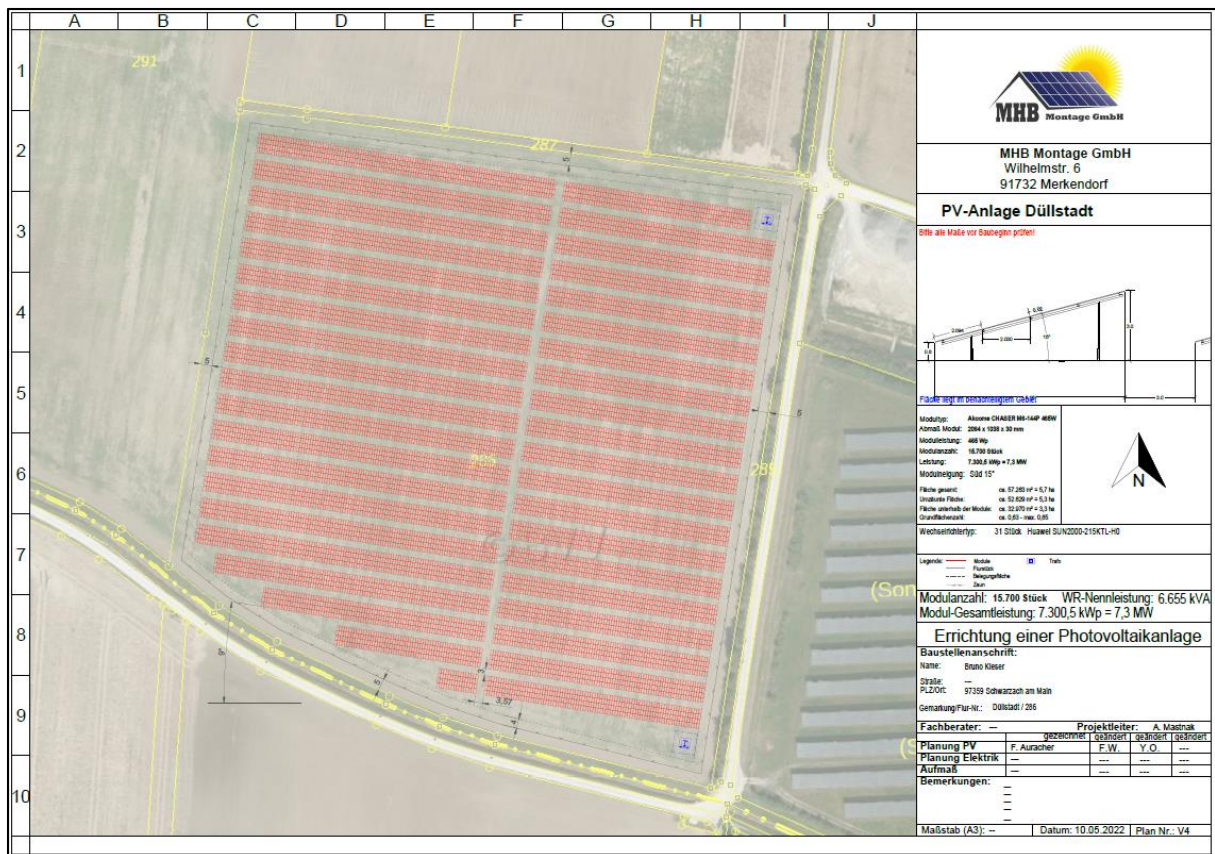
Abbildung 3: Belegungsplan zur geplanten PV-Freiflächenanlage auf Flurstücksnummer 286, Gemarkung Düllstadt, Gemeinde Schwarzach am Main. Zur Verfügung gestellt von der MHB Montage GmbH (Stand 10.05.2022).
